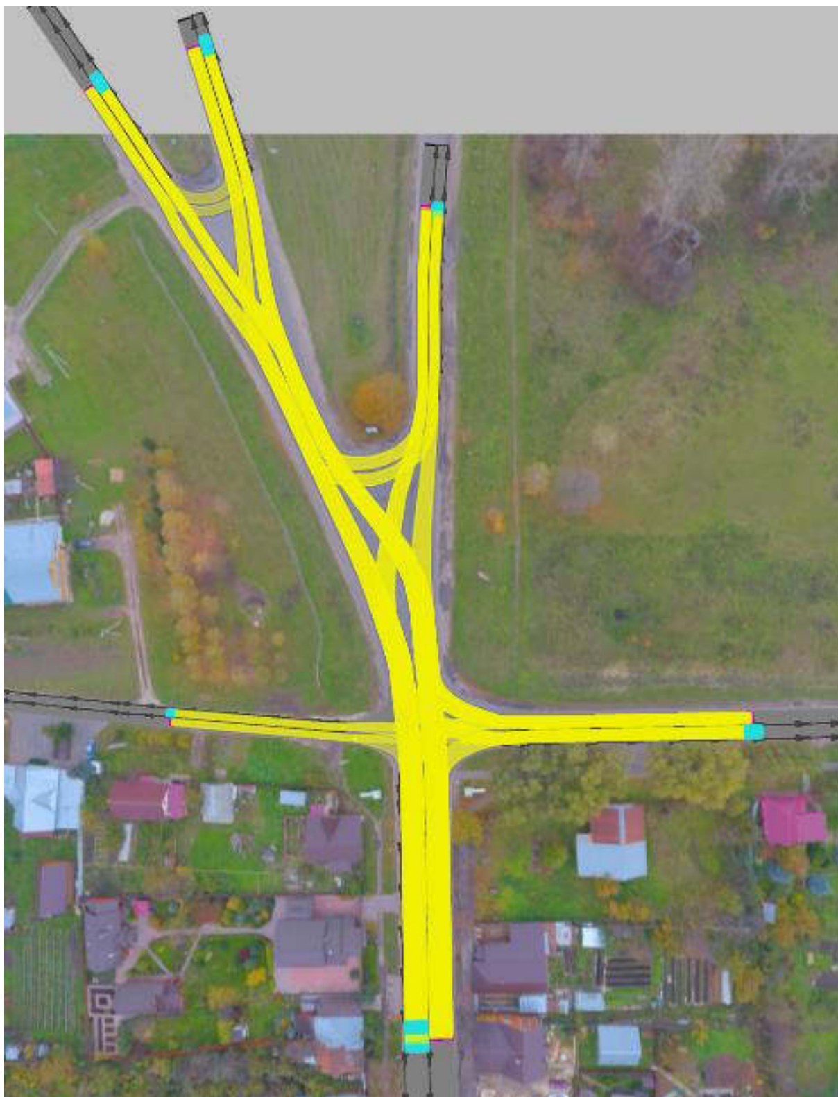
Рисунок 52 – Маршруты движения ТС на пересечении улиц Ленина и Гоголя Для дальнейшего анализа были установлены детекторы измерения длины
