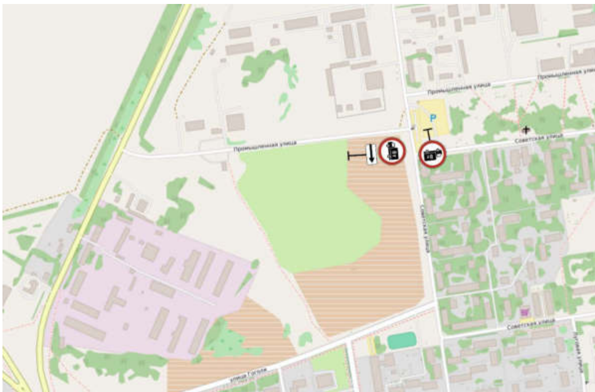
Рисунок 8 – Установка знаков на пересечении ул. Советская и ул. Промышленная
