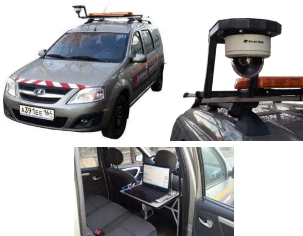
Рисунок 2 – Измерительный комплекс – передвижная дорожная лаборатория КП-514СМП на базе автомобиля «LADA Largus»
