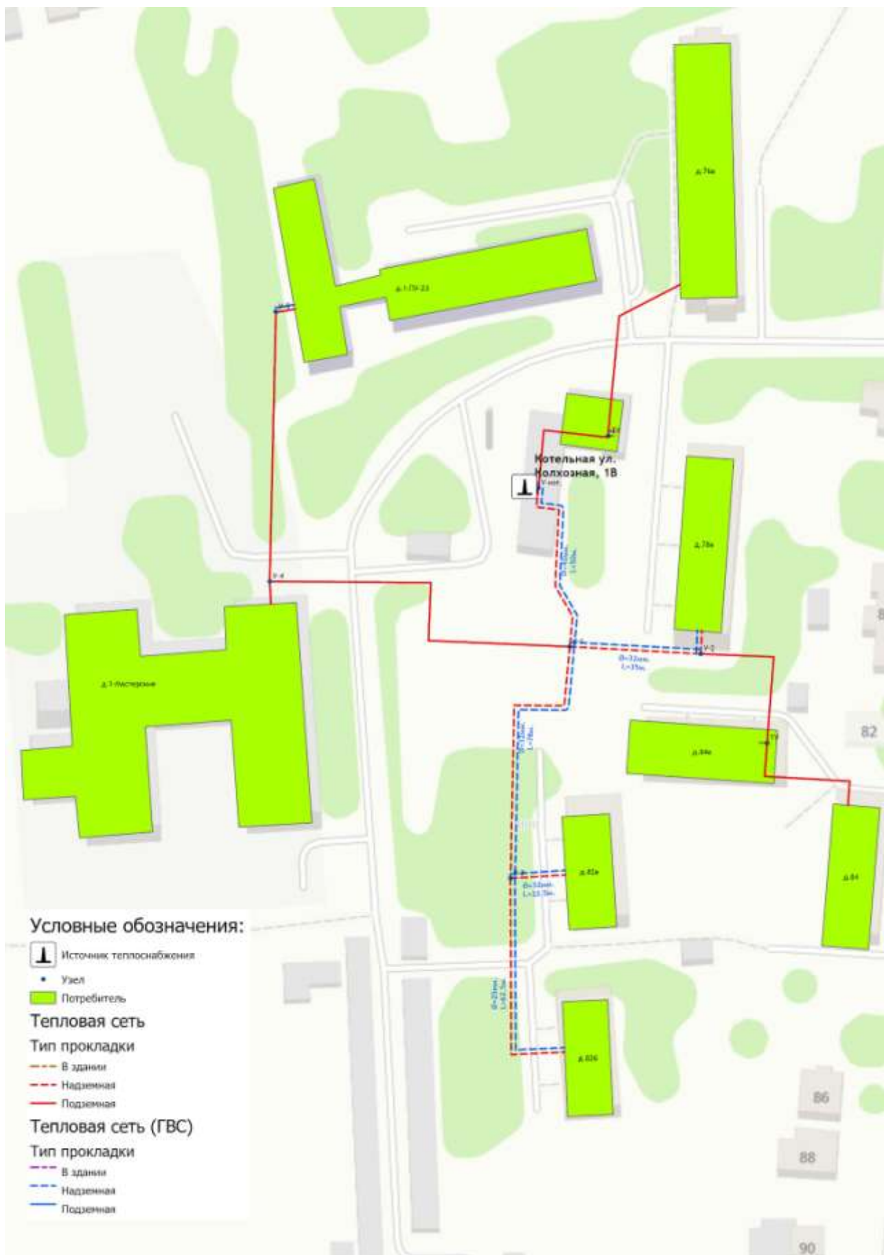
Рисунок 4.9.5 - Схемы тепловых сетей от котельной ул. Колхозная, д. 1
