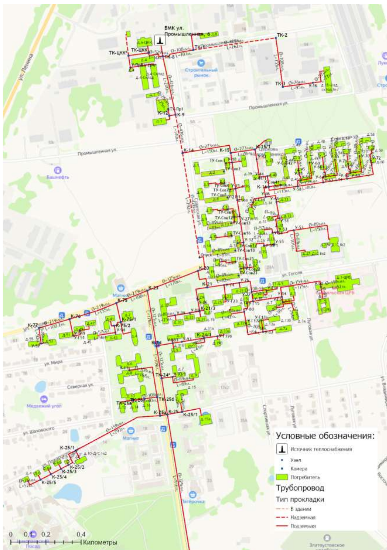
Рисунок 4.9.3 - Схема тепловых сетей от БМК-16 МВт ул. Промышленная, 6
