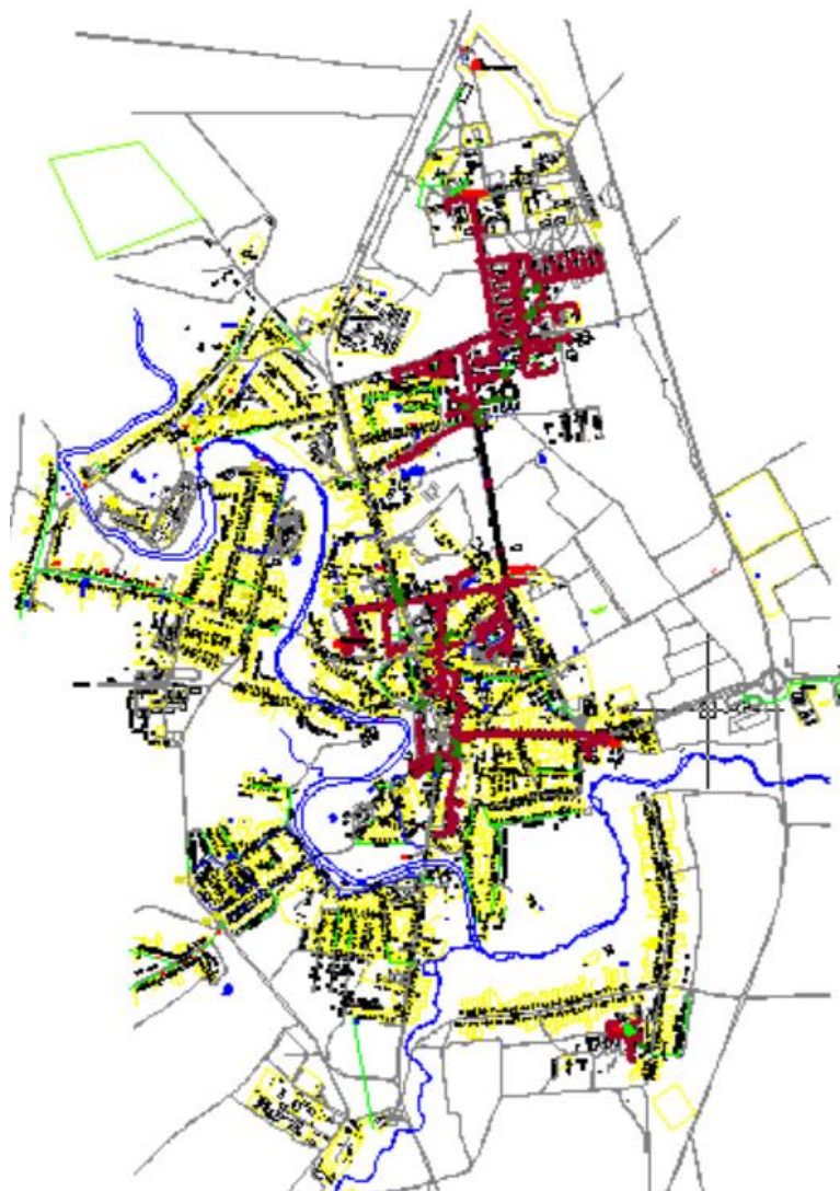
Рисунок 3.1.1.1. – Зоны расположения источников теплоснабжения г. Суздаль
