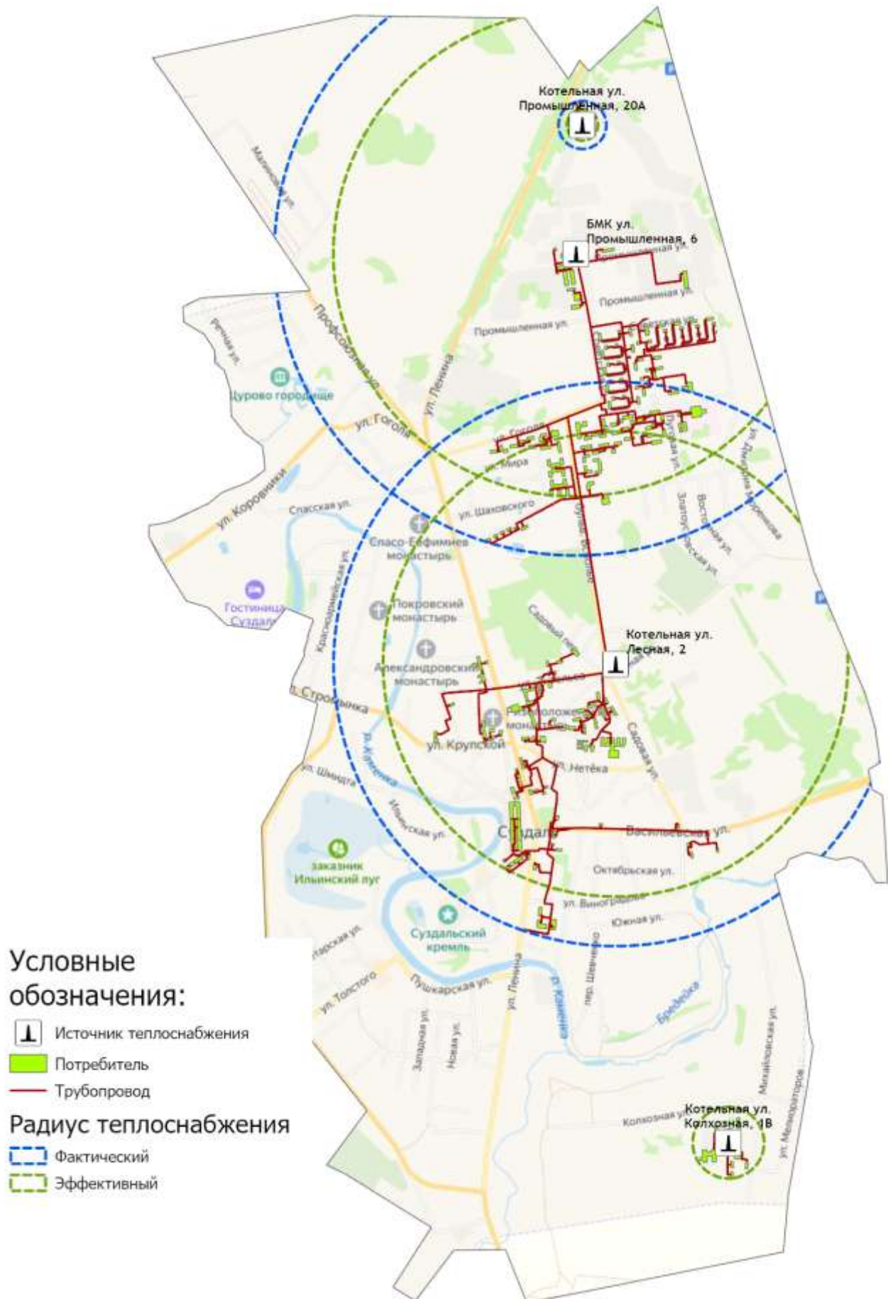
Рисунок 2.5.1 - Радиусы эффективного теплоснабжения котельных г. Суздаль
